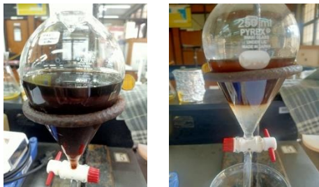
Gambar 3. Tampilan fisik LMG setelah esterifikasi: akhir reaksi (kiri) dan pencucian (kanan)
